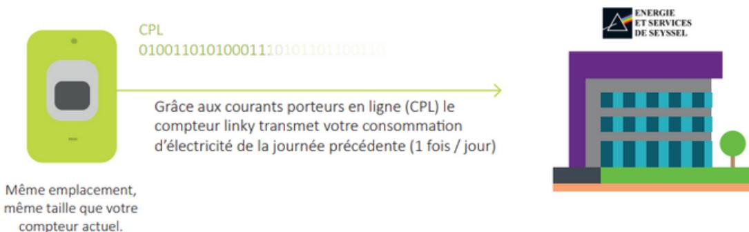
La technologie du C.P.L. existe depuis longtemps et permet de créer un réseau de communications informatiques utilisant les câbles électriques des réseaux de distributions publiques déjà existants. Le compteur ne conduit pas à une augmentation du champ électromagnétique (il est comparable à celui d'une ampoule L.E.D. de 5 Watts).
